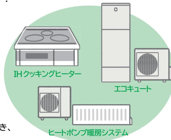
電気エネルギー1を消費して、空気中の熱エネルギーを1以上取り込み、2以上の熱エネルギーを生み出します。
