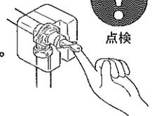
点検しないとタンクや配管が破損したり、逃し弁から水漏れしたりすることがあります。また、水漏れにより電気代、水道代が高くなったり、家屋などへの不具合が発生することがあります。
