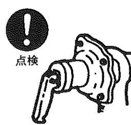
点検しないとタンクが破損したり、逃し弁から水漏れしたりすることがあります。
