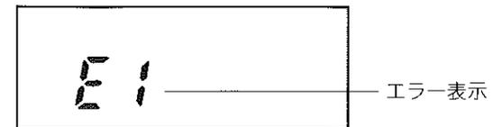
デジタル表示部が「E1」「E2」で点灯したときは、温度検知センサーの異常です。必ず温水器の漏電遮断器の電源レバーを「切(OFF)」にし、据付け工事店にご連絡ください。
