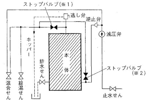
以上の凍結防止方法の他、凍結防止対策が施工されていない場合でも減圧弁を介したシャワーの給水せ側を少し開き水が糸をひく程度に流して凍結防止をする簡便な方法があります。
