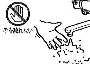
給湯レバーを開くと湯水混合栓からお湯ができます。特に朝の使いはじめは空気の混ざった熱湯が出ることがあります。給湯レバーは少しずつ開いてください。
