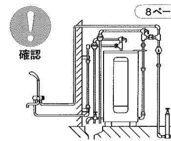
凍結するとタンクや配管が破裂して水漏れでやけどをすることがあります。
