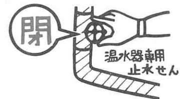
特にマンションなど、中・高層住宅では漏水が下層階へ被害を及ぼす場合がありますので、ときどき点検してください。
