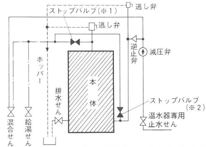
以上の凍結防止方法の他、凍結防止対策が施工されていない場合でも減圧弁を介したシャワーの給水せん側を少し開き水が糸をひく程度に流して凍結防止をする簡便な方法があります。
